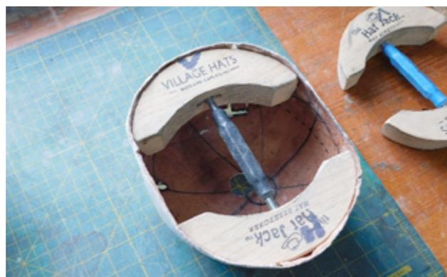
Mit einem Hutspanner wird die Form noch etwas nachgearbeitet
